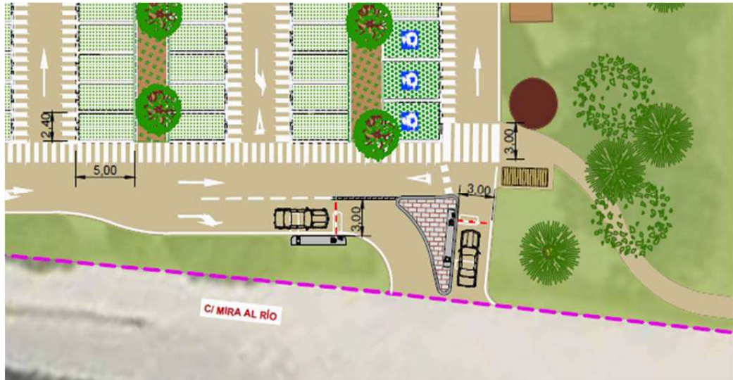
Plazas para Personas de Movilidad Reducida, ubicadas junto al acceso al aparcamiento
