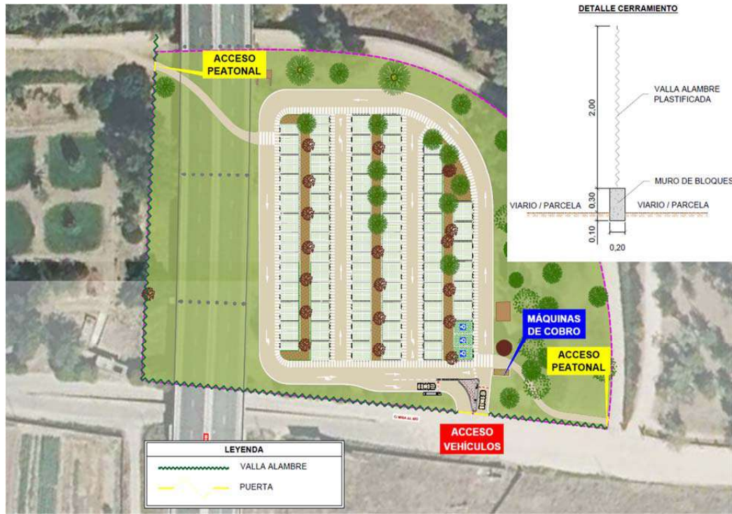
Cerramiento a renovar y puertas de acceso.
