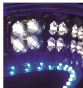
Los 64 LED blancos de alta potencia, distribuidos en 16 módulos, se orientan e inclinan independientemente según el tipo de distribución fotométrica requerida.
