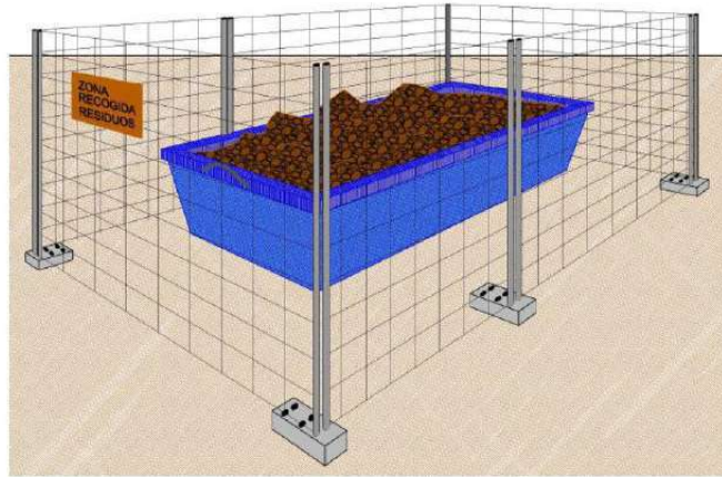
CONTENEDOR DEPOSITO RESIDUOS EN OBRA, CON VALLADO PERIMETRAL
