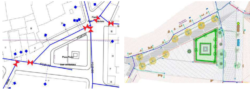
Figura nº 6. Red de abastecimiento. Estado actual y Projectada
