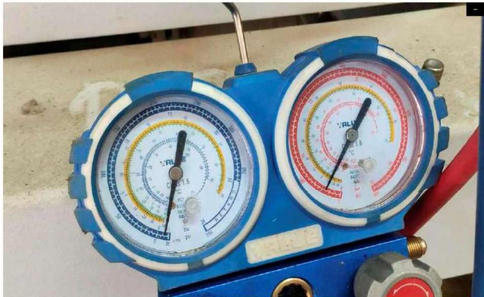
Manómetros para medición de gases refrigerantes
