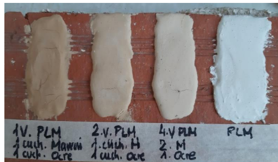
Fig 176 . Pruebas de mortero para estucado o reintegración matérica y cosido de bordes.
